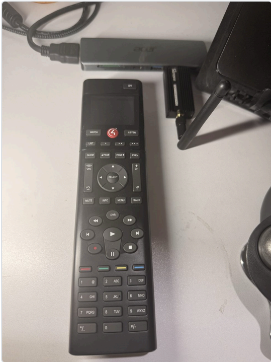
El SR260 (izquierda), el coordinador Sonoff ZBDongle-E con antena (arriba a la derecha, sobre el hub Acer) y el controlador EA-1 (caja negra). El botón rojo con el "4" es el que dispara toda la demo.
