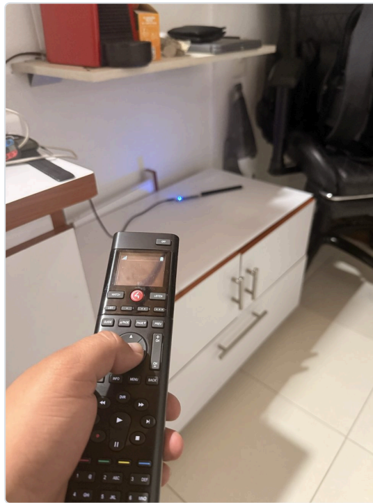
El CatSniffer (sobre el mueble, el LED/antena azul que titila en el video es este dispositivo) capturando 802.15.4 mientras se opera el SR260. Rango dinámico medido en las capturas: -38 dBm a -90 dBm con FCS correcto — prueba de que la antena de 2.4 GHz y el RF switch están en el camino correcto.
