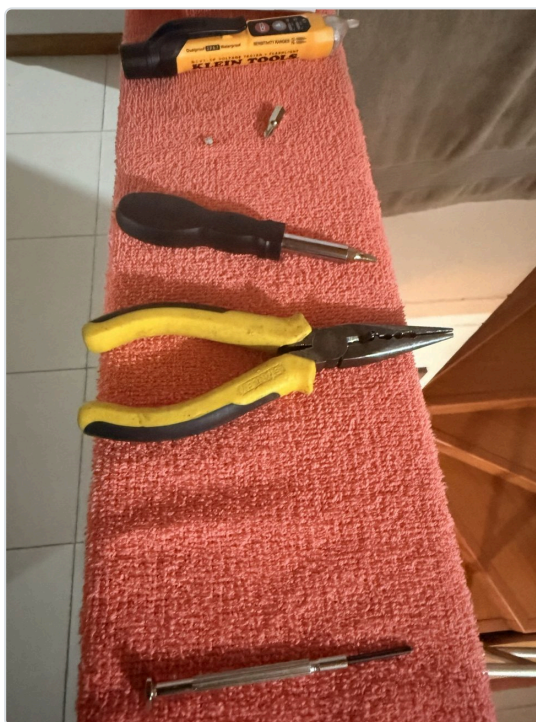
Probador de tensión sin contacto Klein Tools, destornilladores y pinza de punta — el kit para intervenir la caja de pared con seguridad (verificar ausencia de tensión antes de tocar).
