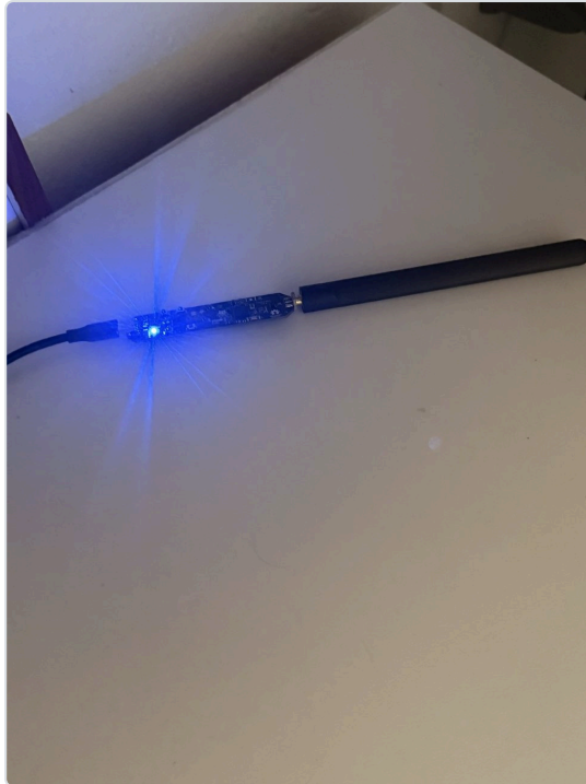
El CatSniffer v3.1 (CC1352P7 + antena de 2.4 GHz) alimentado por USB. Aclaración: la placa con antena que se ve titilar en azul en el video es este CatSniffer — el LED azul parpadeante indica actividad de radio/captura.
